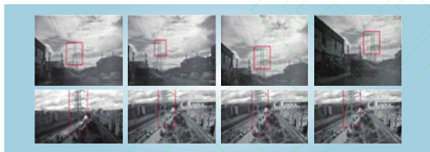
图 7 CBS 直线检测加 ORBGRID 特征提取进行杆塔定位的实验结果
