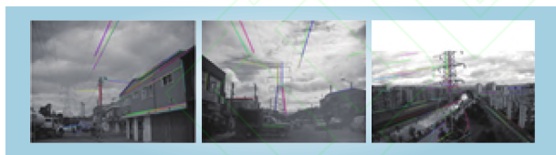
图 1 Hough 变换提取输电线路轮廓
