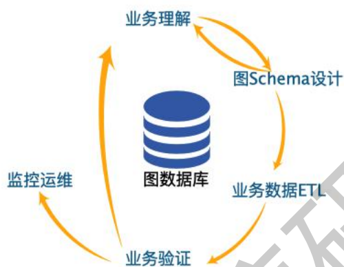
图8 图数据库实施流程
